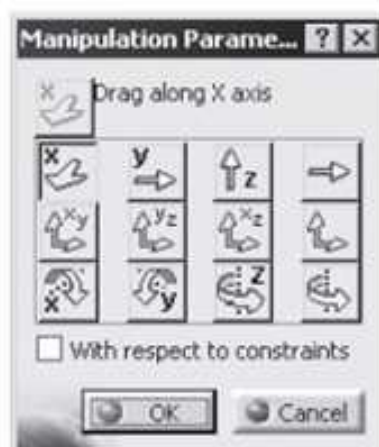
Figure 5 caseta de dialog pentru parametrii de manipulare
