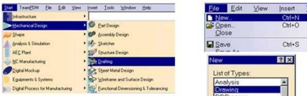
Fig.2 Lansarea în execuție a modulului Drafting
